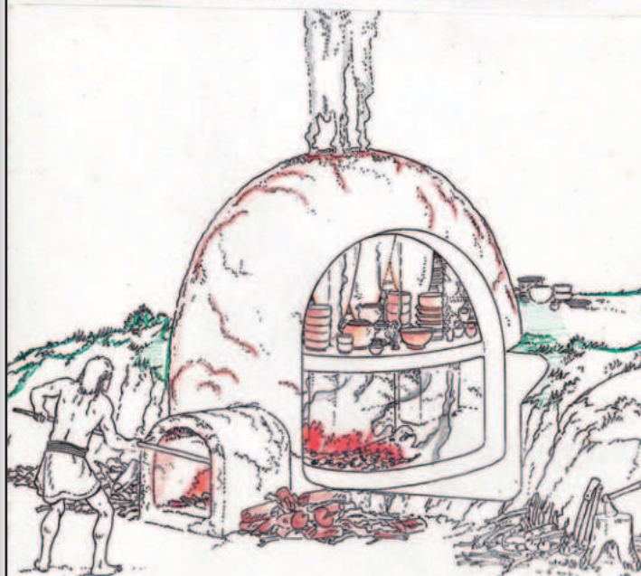
Figura 60. Reconstrucció ideal d'un forn ceràmic de doble cambra (Dibuix: F. Riart)
